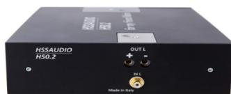
Particolare dorato delle connessioni del segnale D'ingresso RCA, con regolazione di sensibilità completamente separata per ciascun canale L/R nella parte superiore del telaio.
